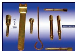
Blokada rozrządu 2,5 / 2,8 CRD Chrysler Voyager
