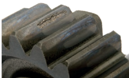
Rys. 2 Uszkodzenie zęba - pitting
