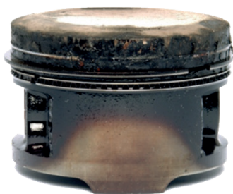
Rys. 1 Zanieczyszczony tłok z zablokowanym pierścieniem spowodowany nadmierną oksydacją oleju silnikowego
